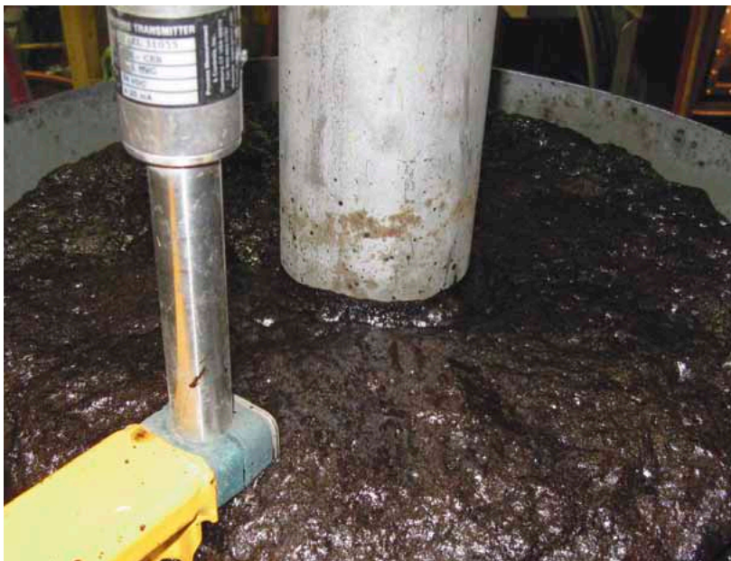
Prueba de flotación a escala del laboratorio de Celdas Jameson en arenas petrolíferas (arriba) y fosfatos (abajo).
